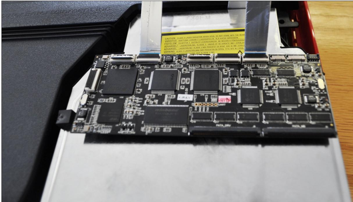
Le Cobra ODE doit être positionner dans la console comme démontrer ci-dessous (CECH4XXX):
