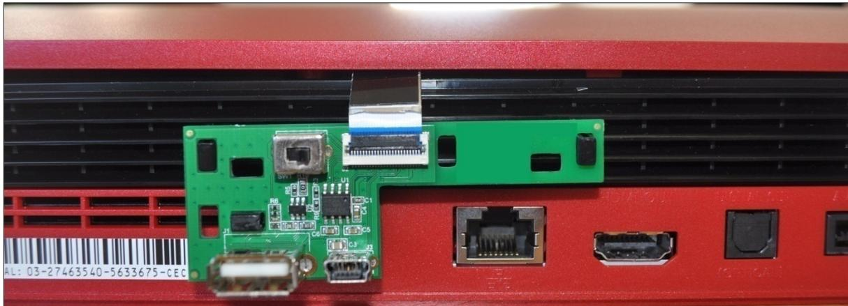
Vous pouvez desormer attacher le connecteur plastique au connecteur du PCB selon le schéma ci-dessous et fixez à l'arriere de votre console comme ci-dessous (CECH4XXX) (Referer vous au tableau pour l'utilisation/l'allocation des connecteurs):
